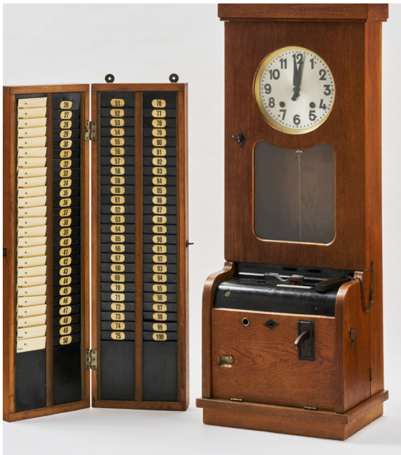
Abb. 1: Eine Stempeluhr mit Kartenapparat einer Pforzheimer Uhrenfabrik aus den 1930er- bis 1950er-Jahren.
